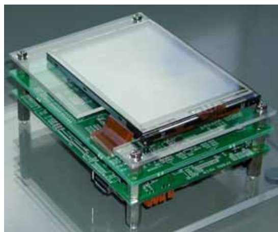
XP880 ボード / SUB ボード / QVGA LCD パネル 実装例
