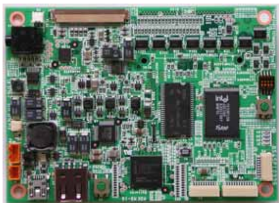
XP880 ボード (PXA270-520Mhz 搭載) 基板サイズ: 80x110 (mm)
